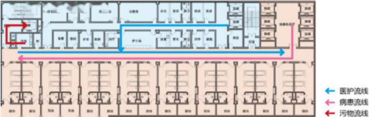
传统综合医院常规病区
